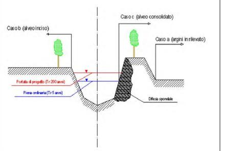
Figura 1 - Sezione tipo di alveo fluviale con individuazione dei punti per la misurazione delle distanze
